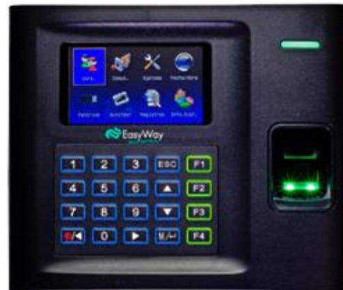
CronoStation soporta hasta 3,000 plantillas de huella o 10,000 tarjetas (125 khz) y hasta 100,000 transacciones.
