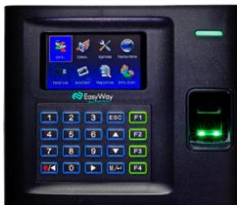
CronoStation soporta hasta 3,000 plantillas de huella o 10,000 tarjetas (Mifare 13.56 MHz) y hasta 100,000 transacciones.
